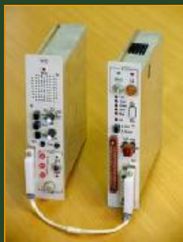
«БОЛТ» - блок окончания линейного тракта для цифровых телефонных станций ИКМ-30
