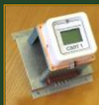
Счетчик энергии, потребляемой троллейбусом с функцией экономайзера
