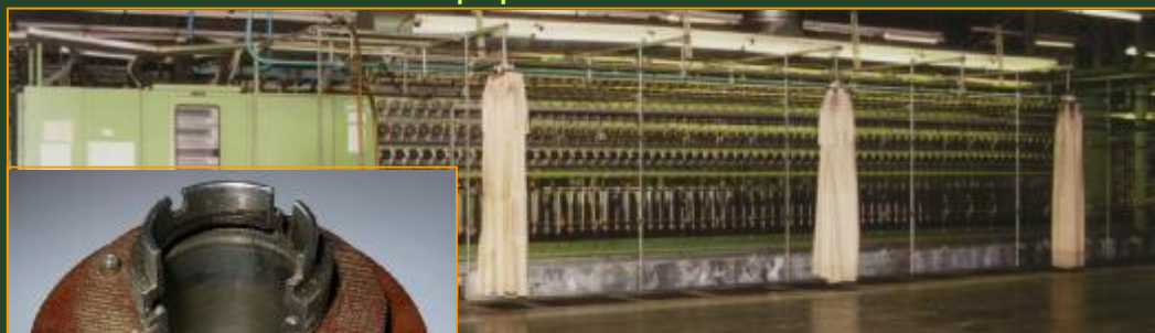
Крутильно-вытяжная машина ЦИНЗЕР-518. Завод полиэфирных нитей ОАО «Могилевхимволокно»
